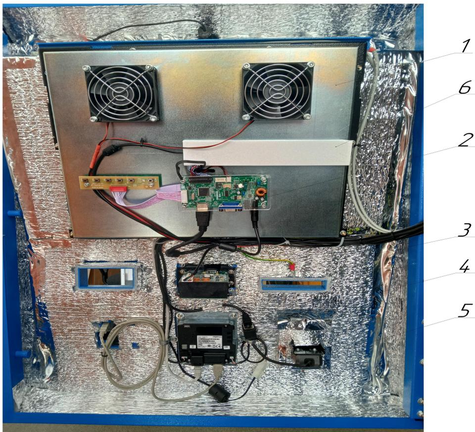
1 — кожух монитора с вентиляторами; 2 — управляющая плата монитора; 3 — картридер топливных карт А18; 4 — пин пад А17; 5- устройство считывания штриховых кодов А5; 6- контроллер сенсорного экрана .
