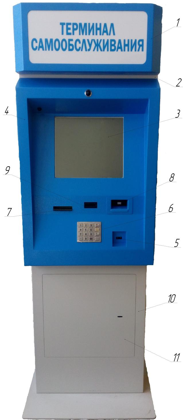
1 — световой бокс; 2 — верхний отсек; 3 — сенсорный экран; 4 — дверка верхнего отсека; 5 — устройство считывания штриховых кодов; 6 — клавиатура пин пад; 7 — отверстие для выхода чеков; 8 — отверстие купюроприёмника; 9 — отверстие для банковских карт; 10 — нижний отсек; 11 — дверка нижнего отсека.
