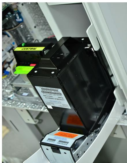
*Фото 11 — Крышка сейфа в открытом положении с купюроприёмником и кассетой*
